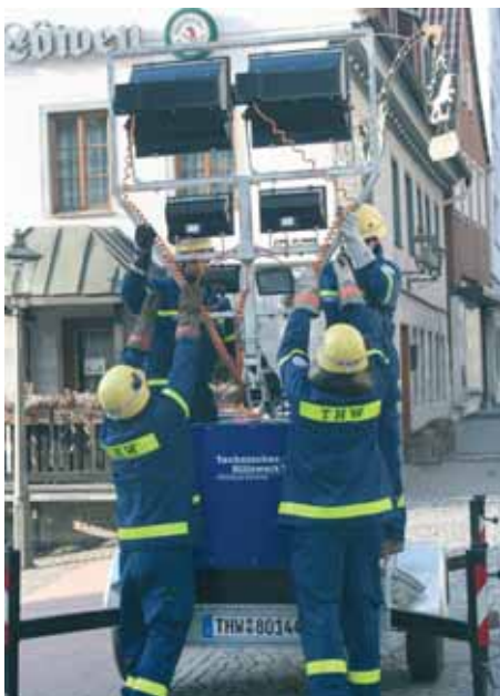
Bei der Konstruktion des Lichtmastes wurde auf eine einfache und leicht bedienbare Bauweise Wert gelegt. Hochgeklappt wird der Mast mit einer mechanischen Winde.
