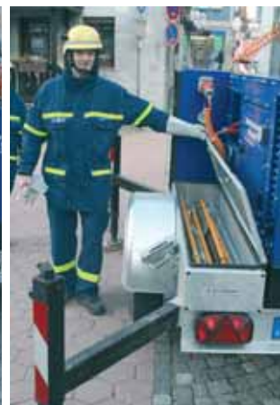
Der Lichtmast wird platzsparend auf dem Dach zusammengefaltet (Fotos oben und links). Vier Stützen sorgen für einen sicheren Stand des Anhängers (Fotos unten links). In zwei abschließbaren Staukästen sind Stativ untergebracht (Foto unten rechts).
