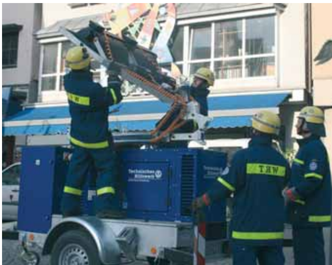
Der Lichtmast wird platzsparend auf dem Dach zusammengefaltet (Fotos oben und links). Vier Stützen sorgen für einen sicheren Stand des Anhängers (Fotos unten links). In zwei abschließbaren Staukästen sind Stativ untergebracht (Foto unten rechts).
