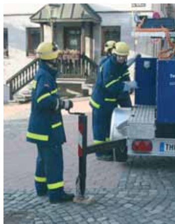
Der Lichtmast wird platzsparend auf dem Dach zusammengefaltet (Fotos oben und links). Vier Stützen sorgen für einen sicheren Stand des Anhängers (Fotos unten links). In zwei abschließbaren Staukästen sind Stativ untergebracht (Foto unten rechts).
