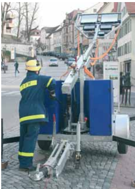
Bei der Konstruktion des Lichtmastes wurde auf eine einfache und leicht bedienbare Bauweise Wert gelegt. Hochgeklappt wird der Mast mit einer mechanischen Winde.
