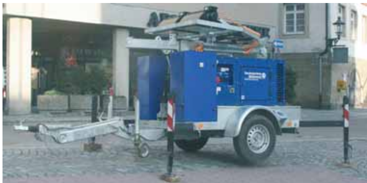
Der Lichtmast wird platzsparend auf dem Dach zusammengefaltet (Fotos oben und links). Vier Stützen sorgen für einen sicheren Stand des Anhängers (Fotos unten links). In zwei abschließbaren Staukästen sind Stativ untergebracht (Foto unten rechts).
